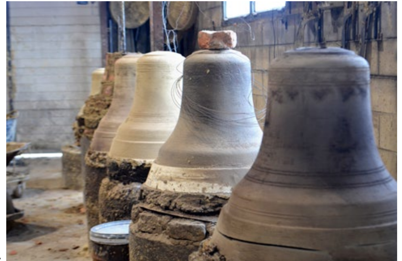
2. Moldes de barro para hacer campanas en el taller de Abel Portilla
