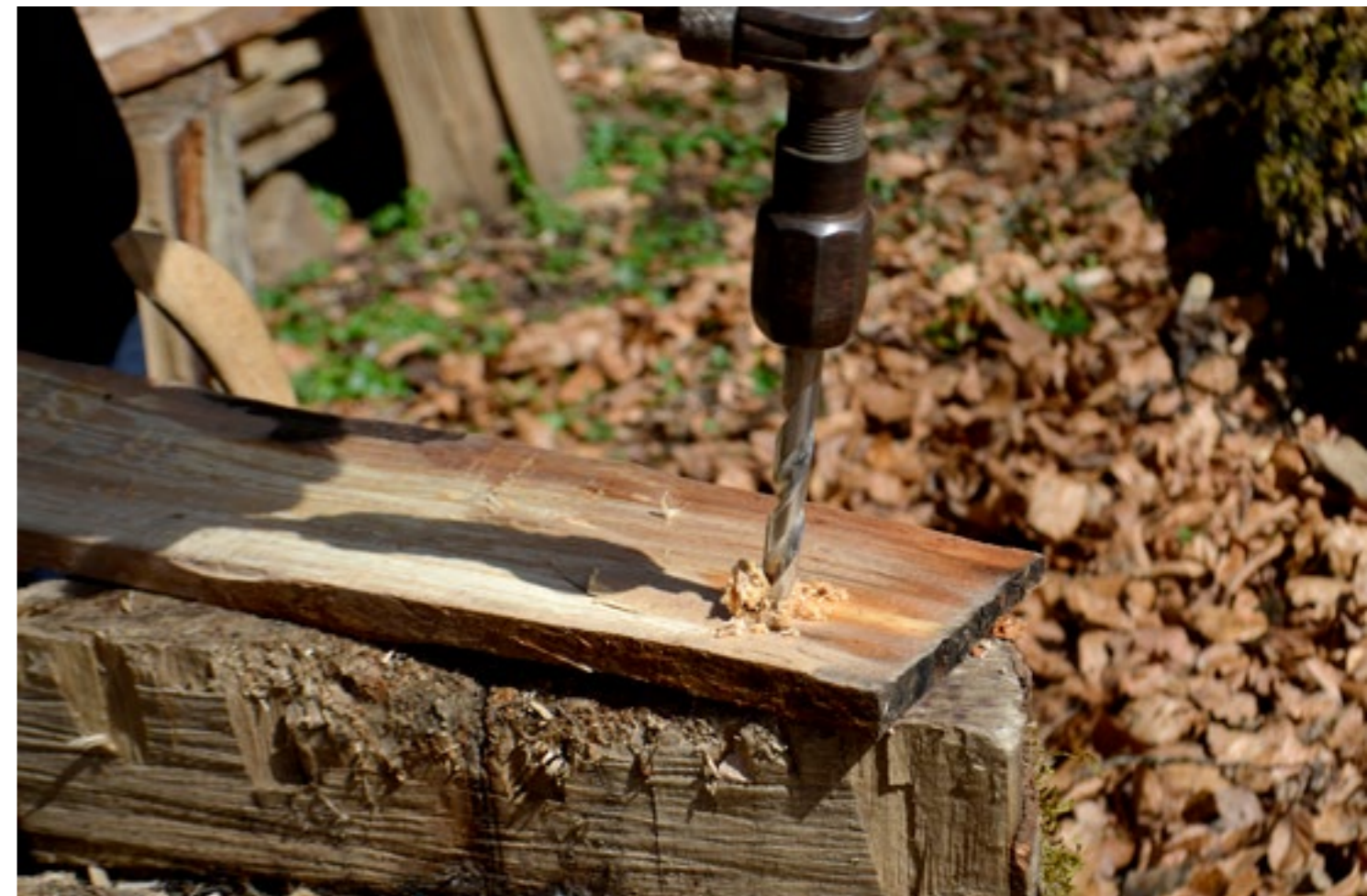
Realización de orificios en las tablillas con la ayuda de un berbiquí para la inserción a presión de las clavijas
