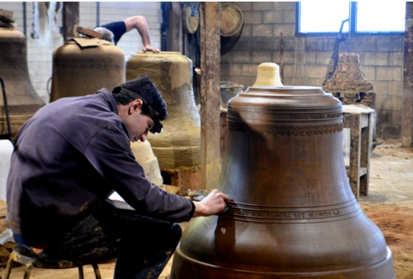
1. Aser Portilla, hijo del maestro Abel Portilla, colocando las letras que formarán parte de los motivos decorativos de una campana 2. Pozo de fundición en Vierna, Cantabria
