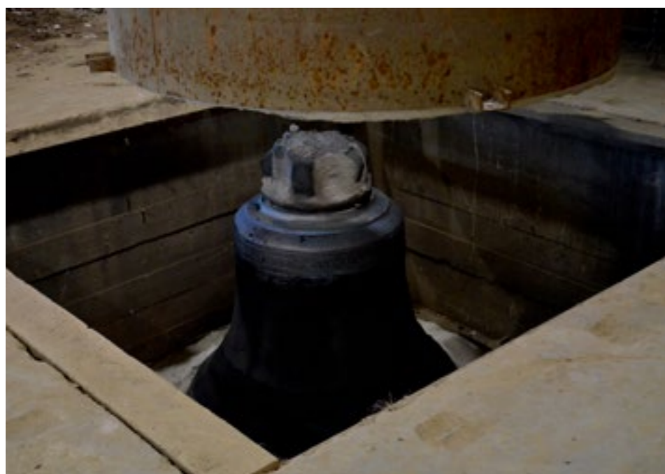
Campana en el foso de fundición, en el taller de Abel Portilla
