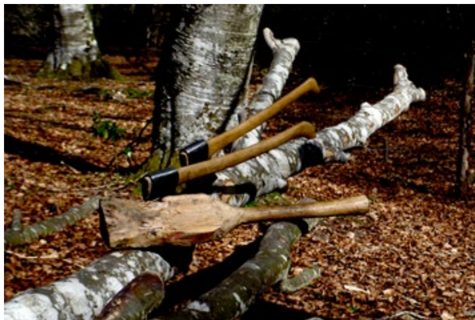
Las hachas y las mazas de madera son las herramientas características del tablillero
