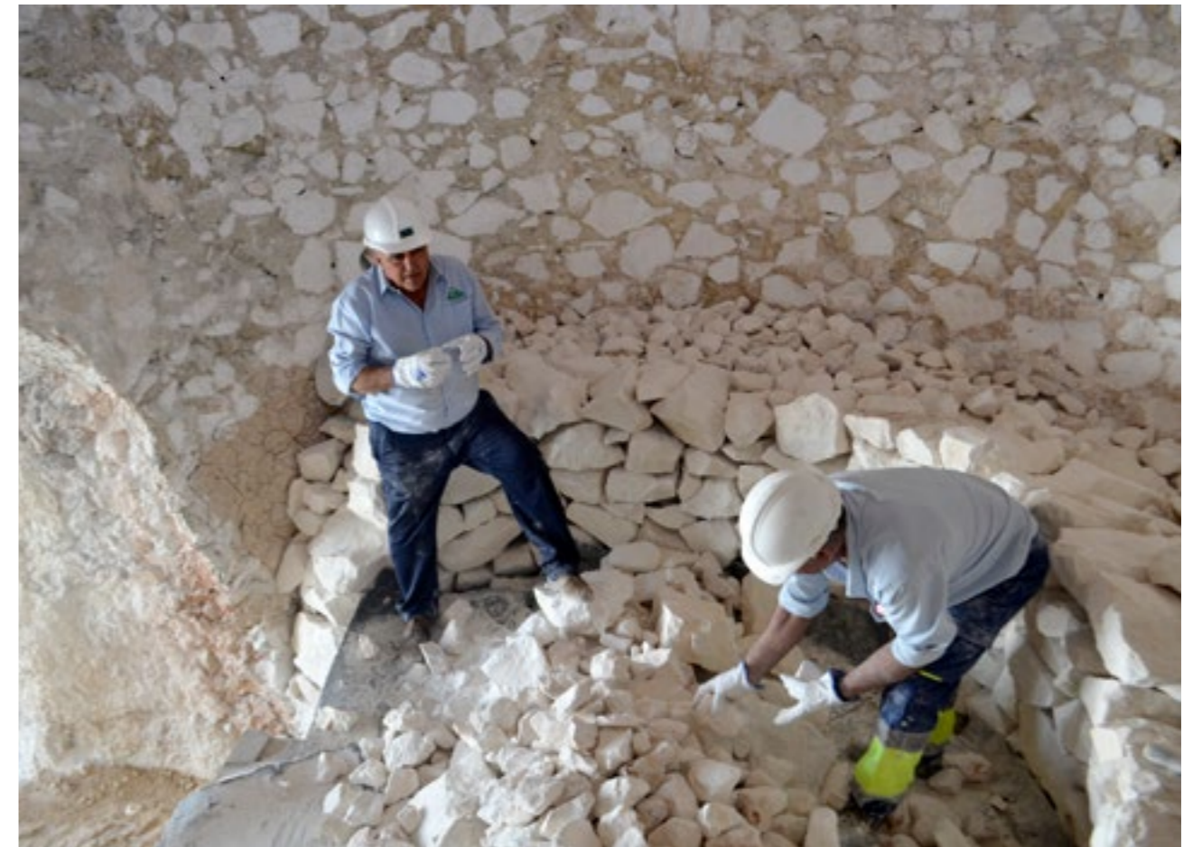
Interior de un horno tradicional de cal
